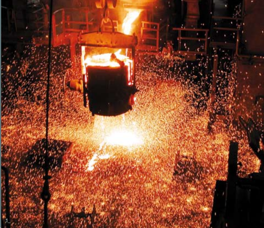
1_ Flüssiges Metall wird aus einem Elektrolichtbogenofen abgegossen.
